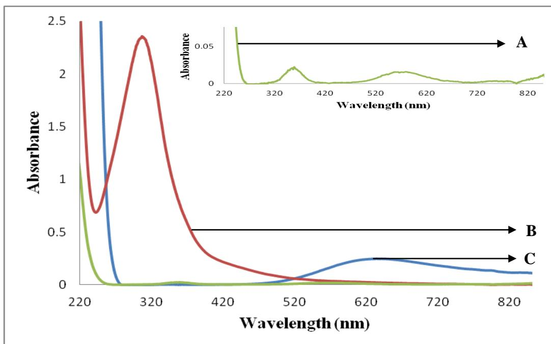
**Figure 3.5:** Absorption spectra of  $[M(NH_3)_4]^{2+}$  complexes at pH 10; A)  $Ni^{2+}$  (10 mL, 0.01 M). B)  $Co^{2+}$  (10 mL, 0.01 M). C)  $Cu^{2+}$  (10 mL, 0.01 M).
